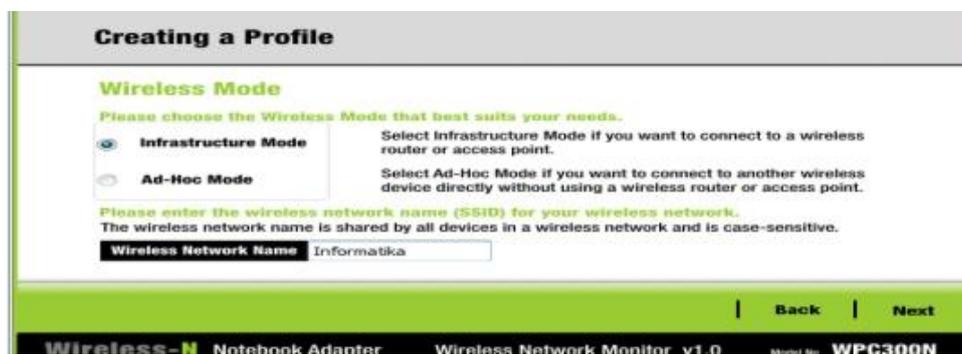
**Gambar 8. Mengatur SSID dan mode**
