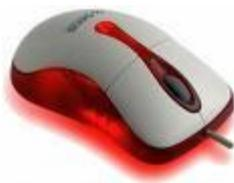
Mouse jenis ini menggunakan teknologi sinar laser atau sinar LED (Light Emitting Diode) untuk mendeteksi pergerakan mouse. dan memantulkannya sehingga mengenai sensor dan menjadi perintah untuk diteruskan ke CPU
