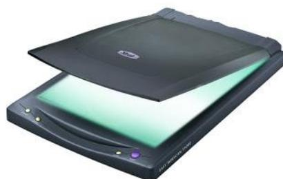
Berfungsi untuk memasukan data analog menjadi data digital dengan cara memindai suatu gambar dari scanner ke dalam sebuah komputer. berfungsi untuk mengcopy / menyalin gambar atau teks yang kemudian disimpan ke dalam memory komputer dengan bentuk image. Scanner hampir mirip dengan
