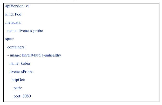
Deskriptor pod mendefinisikan probe liveness probe httpGet, yang memberi tahu Kubernetes untuk melakukan permintaan HTTP GET secara berkala di jalur / di porta 8080 untuk menentukan apakah kontainer masih sehat. Permintaan ini dimulai segera setelah kontainer dijalankan.
