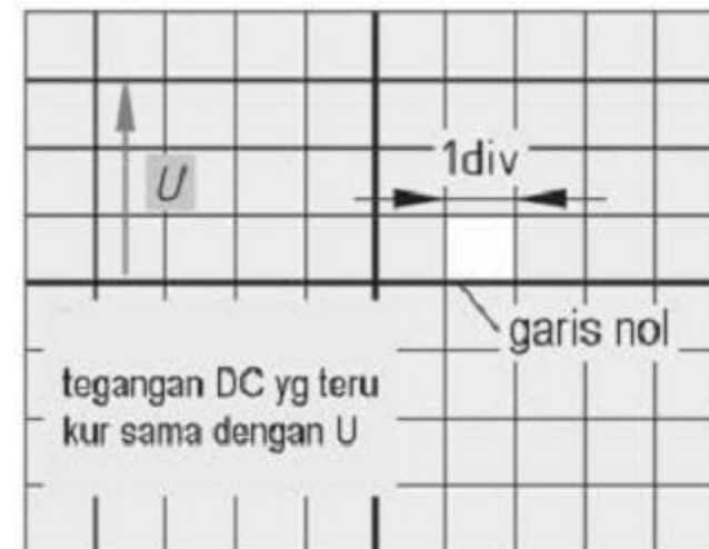
Gambar 8.38 Mengukur tegangan DC dengan osiloskop
