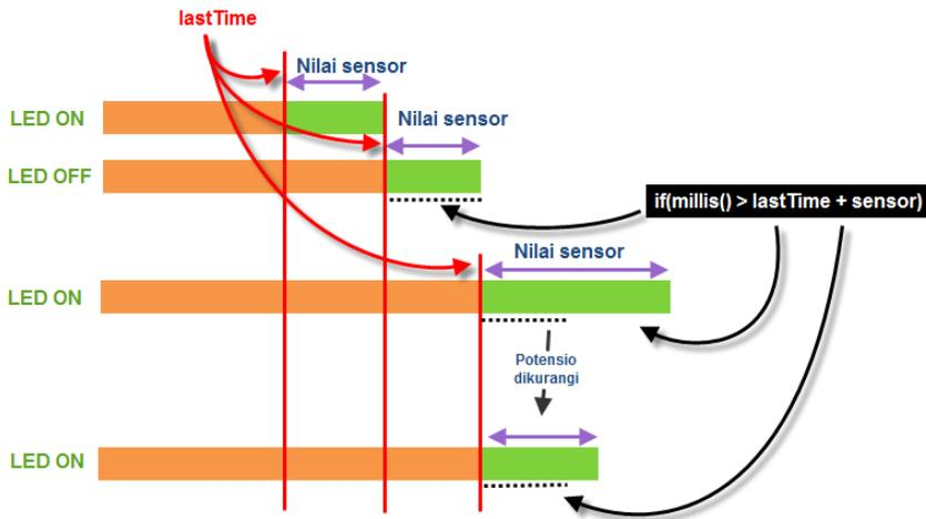
Gambar 3.5 Siklus perubahan status LED dan potensiometer
