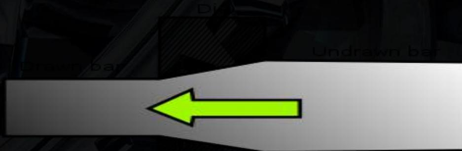
Yaitu suatu proses pembentukan material. Draw ini merupakan proses awal pada mesin press / stamping sebelum di lanjutkan ke proses-proses berikutnya. Untuk proses draw ini bisa dilakukan untuk 2 kali proses.
