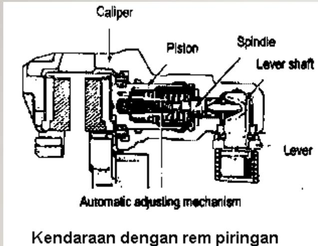
Mekanisme rem parkir disatukan dalam caliper rem
