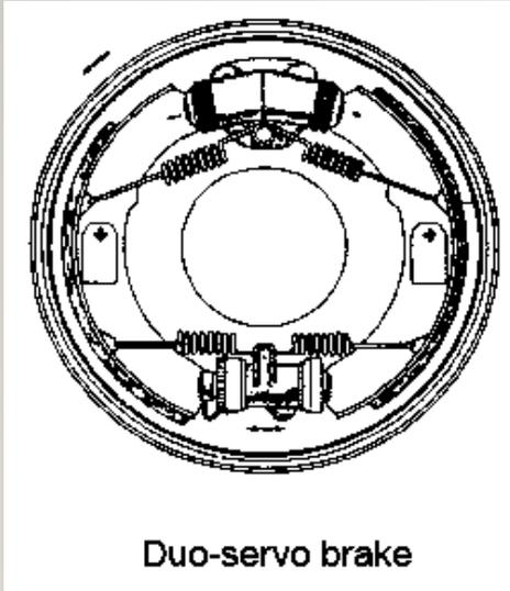
Tipe ini merupakan penyempurnaan dari tipe Uni servo. Jadi rem jenis ini menggunakan satu wheel cylinder dengan dua piston dan adjusting cylinder yang dapat bergerak bebas. Sehingga pada saat kendaraan bergerak maju atau mundur kedua sepatu rem berfungsi sebagai leading shoe.
