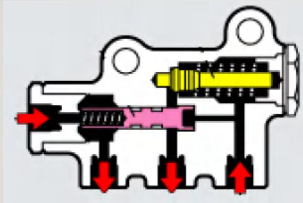
Cara kerja saat tekanan master cylinder rendah pada blend valve sama dengan cara kerja saat tekanan master cylinder rendah pada proportioning valve
