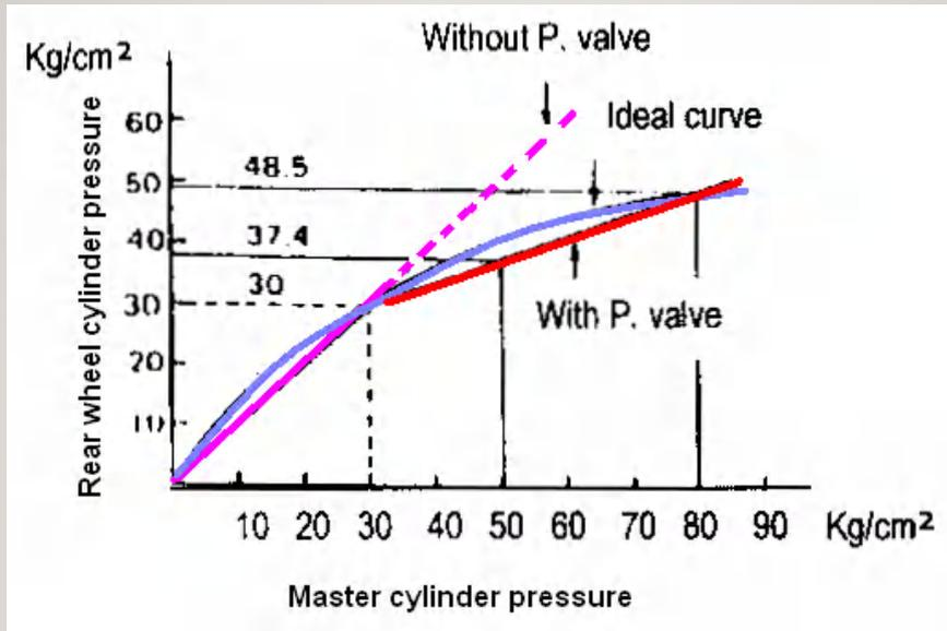
Dengan alasan beban berat kendaraan yang lebih berat pada bagian depan pada saat terjadi pengereman, maka diperlukan proporsioning valve untuk mengurangi tekanan hidraulis untuk silinder roda belakang, sehingga mencegah terjadinya terjadinya ngepot. Proporsioning valve ditempatkan pada pipa rem yang ke bagian belakang.
