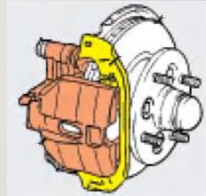
Pada tipe ini hanya terdapat satu piston. Tekanan hidrolis dari master cylinder mendorong piston ( A ) dan selanjutnya menekan disc. Pada saat yang sama tekanan hidraulis menekan sisi pad ( B ) menyebabkan caliper bergerak ke kanan dan menjepit cakram dan terjadilah pengereman
