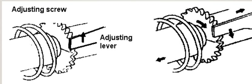
Pada saat celah mencapai harga standar ( celah sepatu rem dengan tromol +/- 0,5 mm, maka adjusting lever hanya gerberak sedikit ( tidak dapat mengait gigi adjusting screw ). Sehingga celah sepatu rem tetap.
