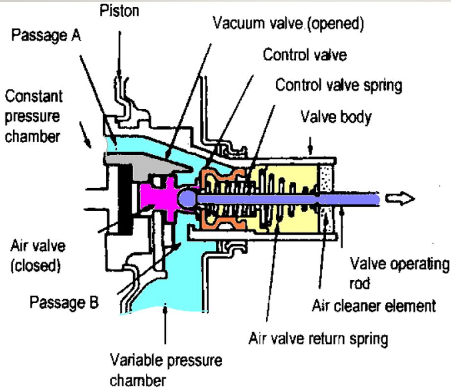
Air valve tertarik ke kanan oleh air valve return spring, bertemu dengan kontrol valve sehingga tertutup. Dan udara luar tidak bisa masuk ke variable pressure chamber. Vacuum valve terbuka menyebabkan terjadinya kevacuuman pada constant dan variable pressure chamber. Piston terdorong ke kanan oleh pegas diaphragma
