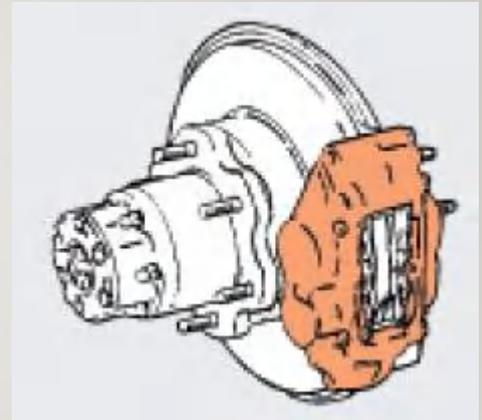
Pada tipe ini daya pengereman didapat bila pad ditekan piston secara hidraulis dari kedua sisi disc
