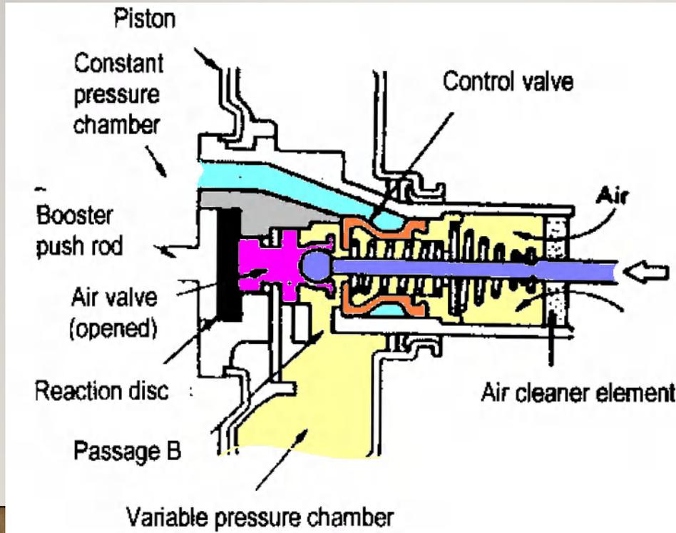
Valve operating rod mendorong air valve control valve, menyebabkan vacuum valve tertutup dan air valve terbuka hal ini menyebabkan udara luar masuk ke variable pressure chamber. Perbedaan tekanan antara variable dan constant pressure chamber menyebabkan piston bergerak ke kiri
