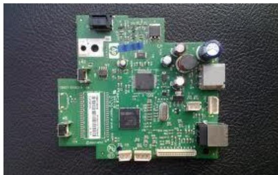
Gambar 4.6.7. : Mainboard Printer
