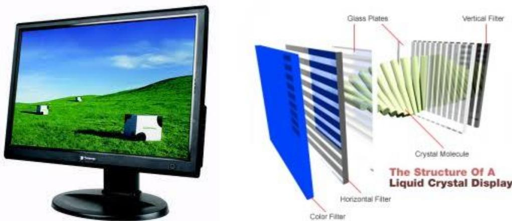
Monitor LCD tidak lagi menggunakan tabung elektron tetapi menggunakan sejenis kristal liquid yang dapat berpendar. Teknologi ini menghasilkan monitor yang dikenal dengan nama Flat Panel Display dengan layar berbentuk pipih, dan kemampuan resolusi yang lebih tinggi dibandingkan dengan CRT. Karena bentuknya yang pipih, maka monitor jenis flat tersebut menggunakan energi yang kecil dan banyak digunakan pada komputer-komputer portabel.
