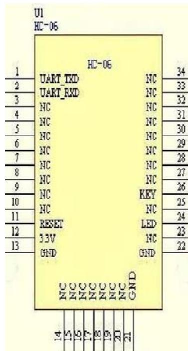
Gambar 4.7 Konfigurasi Pin-Pin Bluetooth HC-06
