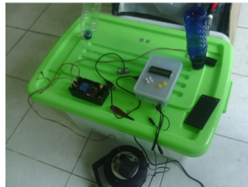
Sistem Instrumentasi dan Pengendalian EC dan pH Larutan Nutrisi
