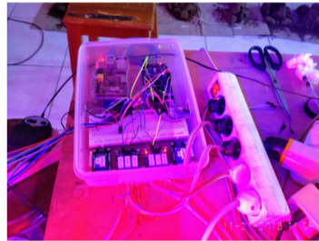
Sistem Instrumentasi dan Pengendalian Parameter Iklim Mikro
