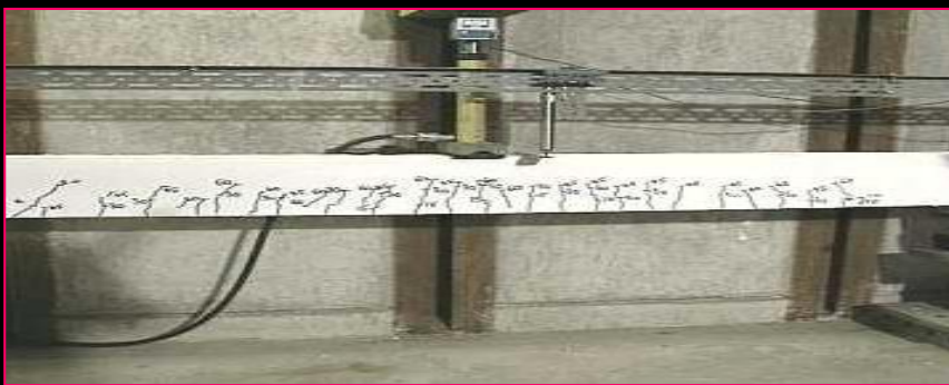
Pola Retak beban 60 kN
