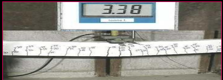
Pola Retak Beban ultimit 33,8 kN
