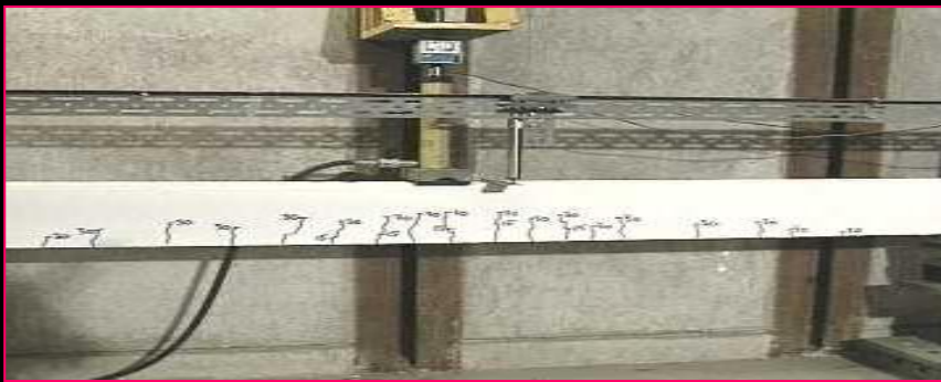
Pola Retak beban 30 kN
