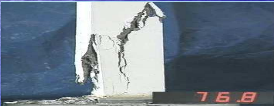
Kondisi Final Failure
