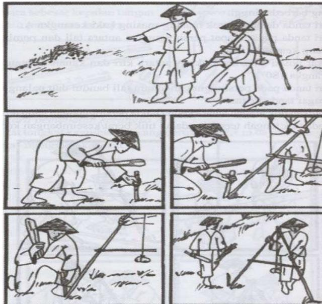
Gambar 12. Teknik Pembuatan Kontur dengan Kerangka A
