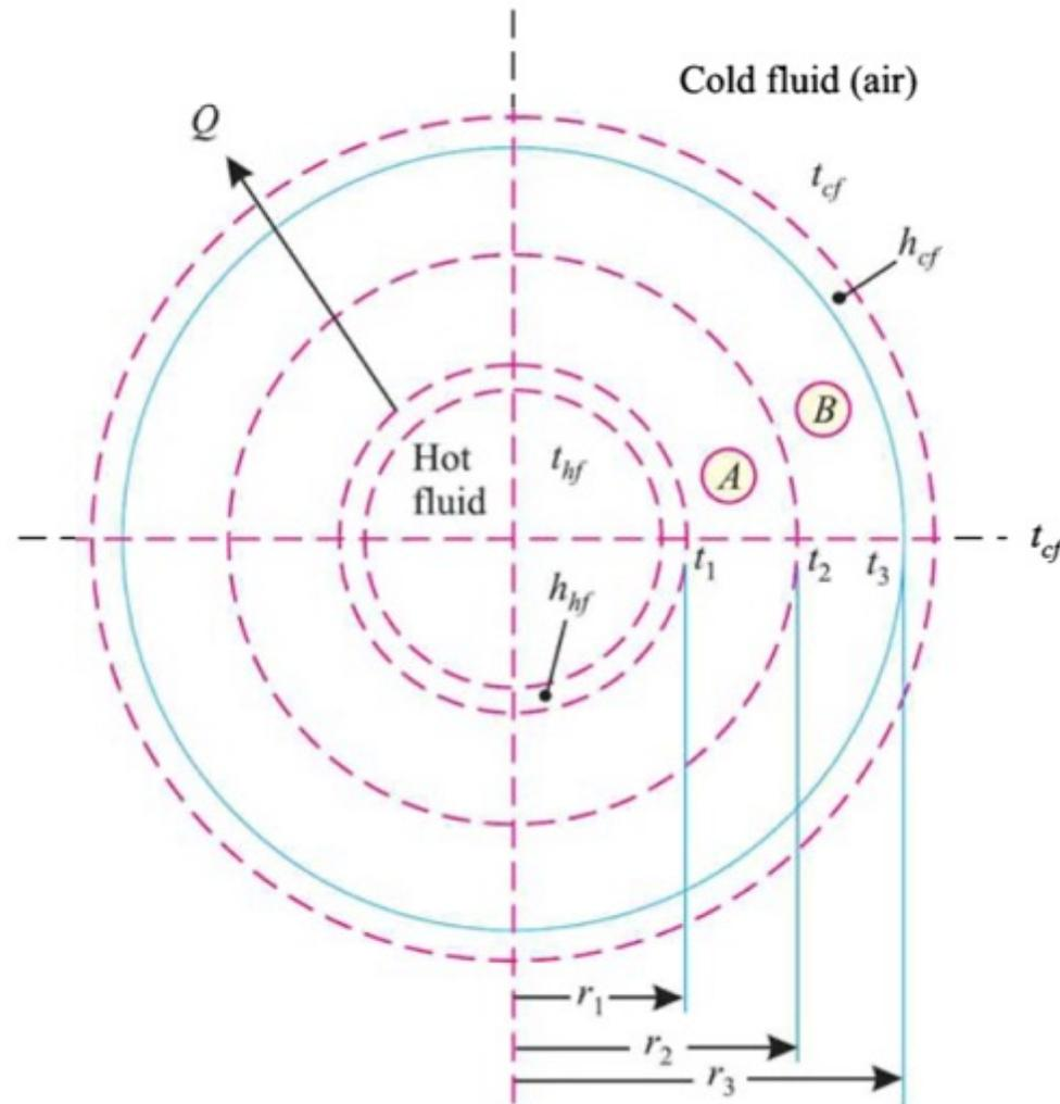
$$\frac{Q}{4\pi} \left[ \frac{1}{h_{hf} \cdot r_1^2} + \frac{(r_2 - r_1)}{k_A \cdot r_1 r_2} + \frac{(r_3 - r_2)}{k_B \cdot r_2 r_3} + \frac{1}{h_{cf} \cdot r_3^2} \right] = t_{hf} - t_{cf}$$
