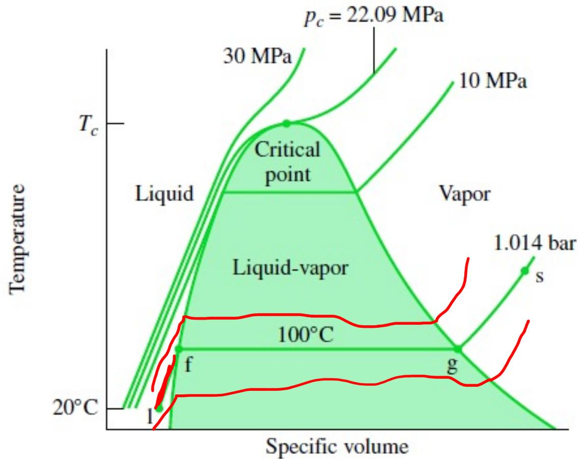
**Sketsa diagram temperatur – volume spesifik untuk air yang menunjukkan cairan, dua fasa cairan-uap dan daerah uap**
